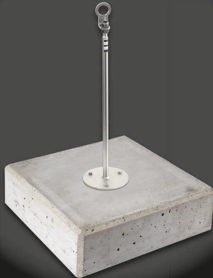
Das TigaSAFE „easy 3 System“ kann als Einzelanschlagpunkt und/oder als Anschlagpunkt in einem Seilsystem (Typ C) verwendet werden. Das TigaSAFE „easy 3 System“ ist speziell für Betonuntergründe entwickelt worden. Durch die optimale plastische Verformung der 20 mm Volledelstahlstütze ist ein sanfteres Auffangen des Benützers gegeben. Durch die 3-Punkt-Befestigung und durch das
