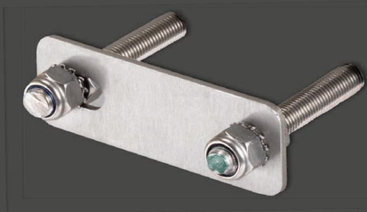
Das TigaSAFE Wandsystem kann als Einzelanschlagpunkt und/oder als Anschlagpunkte in einem Seilsystem (Typ C) verwendet werden. Die Stützen sind einfach mittels HILTI HIT-Kleber in den Betonuntergrund einzukleben (siehe Montageanleitung).
