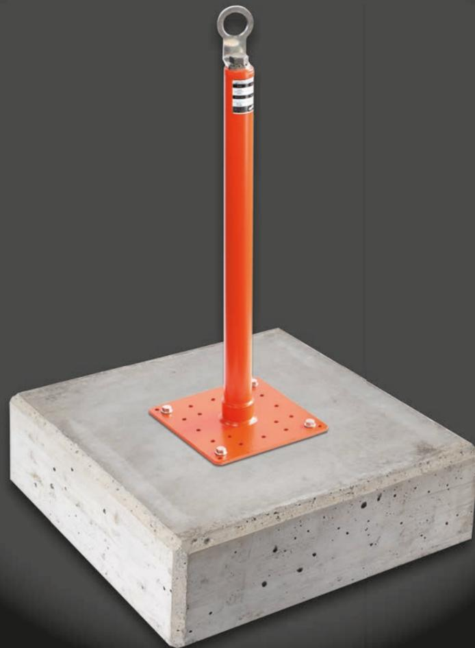
Der TigaSAFE ESP-Anschlagpunkt ist speziell für Betonuntergründe konzipiert. Weiters ist er in Verwendung mit einer Ringschraube (M16) als Abseilstütze, die für bis zu max. 300 kg Abseilgewicht ausgelegt ist, geeignet. Die ESP-Anschlagpunkte werden besonders sicher und einfach auf Beton befestigt – mittels selbstschneidenden Betonschrauben, die standardmäßig mitgeliefert
